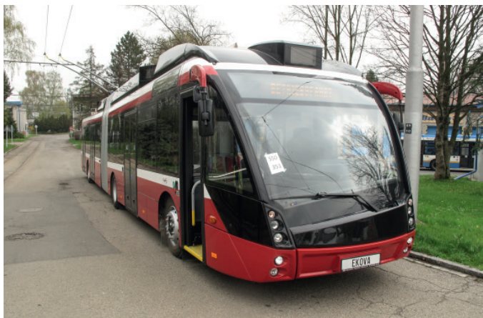
Abb. 12: Solaris Trollino Metro Style/ Cegelec für Salzburg in Ostrava bei Ekova für Montage und Tests.
