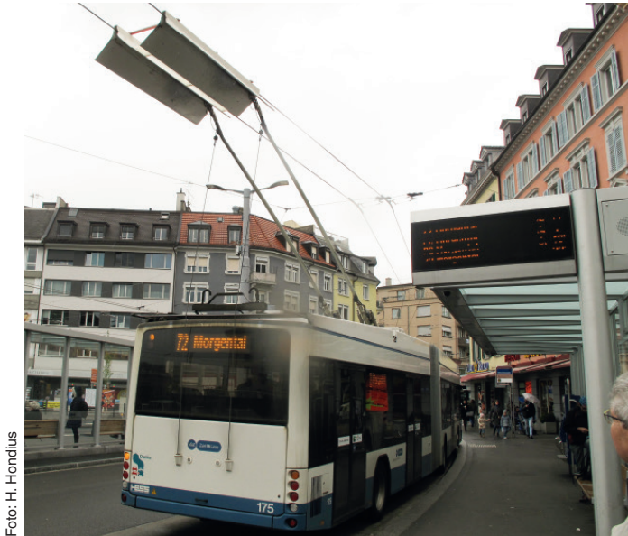
Abb. 8: Anschließend drahtet der Bus am Albisriederplatz wieder ein und fährt weiter als Trolley.
