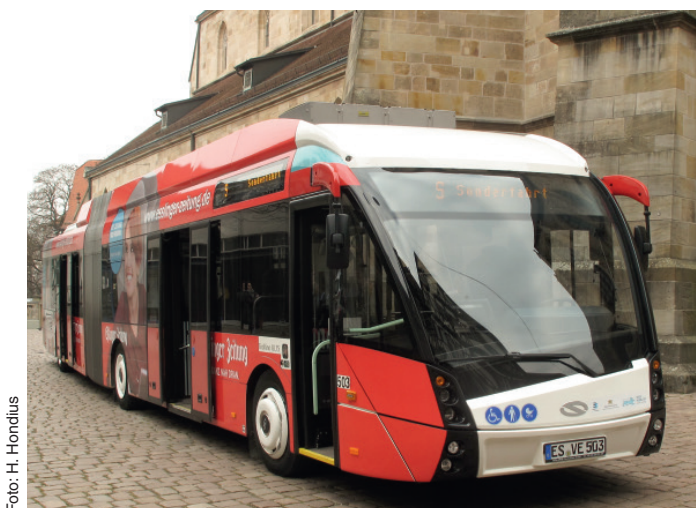
Abb. 10: Solaris Trollino 18 Metro Style/Kiepe Trolley-Batteriebus der SVE in Esslingen.
