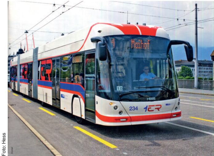
Abb. 3: Doppelgelenk-Trolleybus von Hess/Kiepe in Luzern auf der Schnellbuslinie 1, die nach Ebikon verlängert wird.
