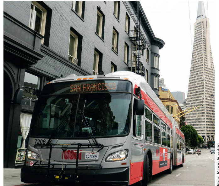
Abb. 9: New Flyer/Kiepe-Gelenktrolley in San Francisco mit Batteriehilfsantrieb und Skoda-Motoren.
