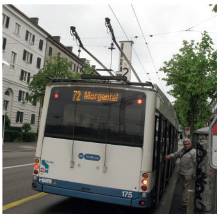
Abb. 7: Gelenk-Trolley 175 der Verkehrsbetriebe Zürich. Der Bus drahtet am Hardplatz ab und fährt als Batteriebus bis zum Albisriederplatz.
