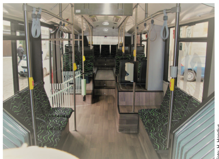
Abb. 11: Solaris Trollino der SVE mit erhöhter Plattform zur Unterbringung der Batterien.
