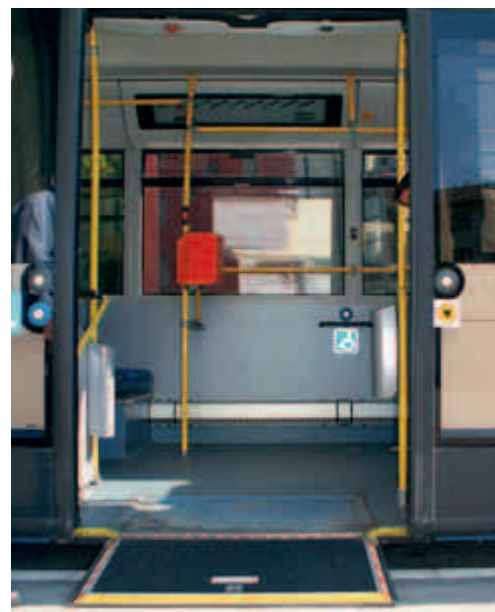
Ebene Zufahrt: Der Swisstrolley3 mit seinem tiefen Einstieg (Kneeling) und der ausklappbaren Rampe ist auch rollstuhlgängig.
