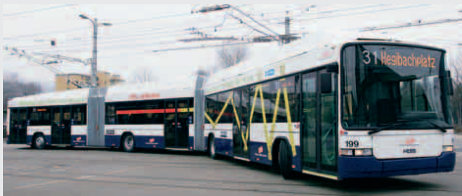
Endlos: Von vorne bis zuhinterst bietet der Doppelgelenk-trolleybus eine Niederflurplattform von rund 24 Meter Länge.
