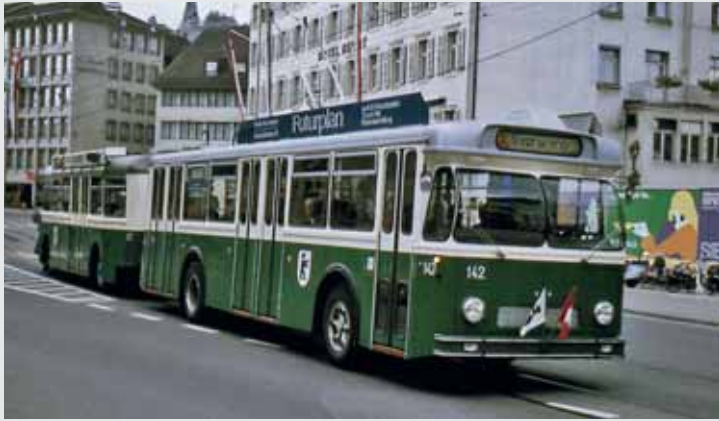
Pioniere: Trolleybus Saurer/Hess/BBS in Aluminium mit Anhänger aus dem Jahre 1967.
