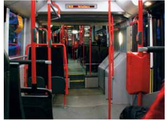
Zwei Etagen: Vom Gelenk 2 gelangt man über zwei Stufen vom Niederflerteil in den erhöhten Vorderwagen.
