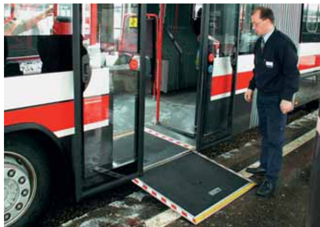
Bequem: Der Einstieg des Niederflerteils ist nur 32,7 Zentimeter hoch. Ruedi Künzler zeigt uns die einfach zu bedienende Klapprampe bei Türe 4.
