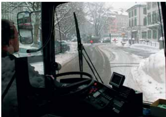
Wendig: Entspannt lenkt Ruedi Künzler das lighTram durch den eingeschränkten Verkehrsraum. Im Rückspiegel erkennt er den Nachläufer. Der Zusatzbildschirm zeigt ihm das Bild des Passagiererraums im Heck.
