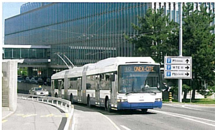
In Genf (Schweiz) fahren die 24m Doppelgelenkbusse von Hess mit der Elektroausrüstung Vossloh.
