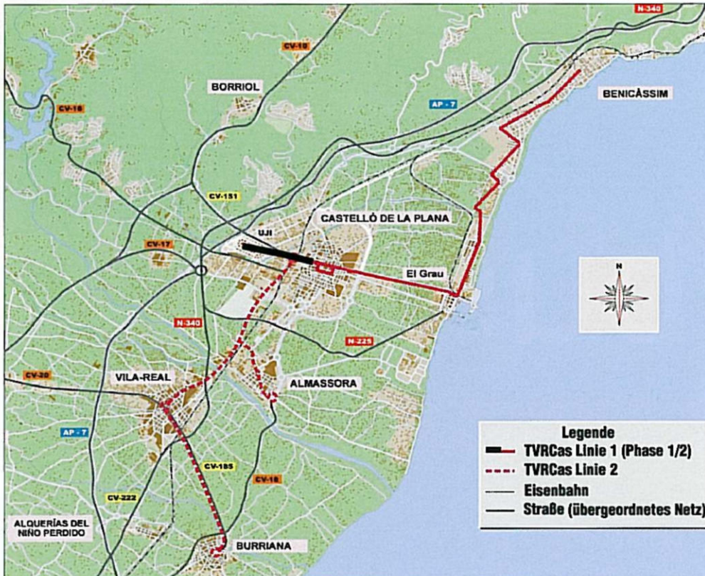
Spurgeführtes Obussystem TVRCas: Streckennetz und Ausbauphasen
