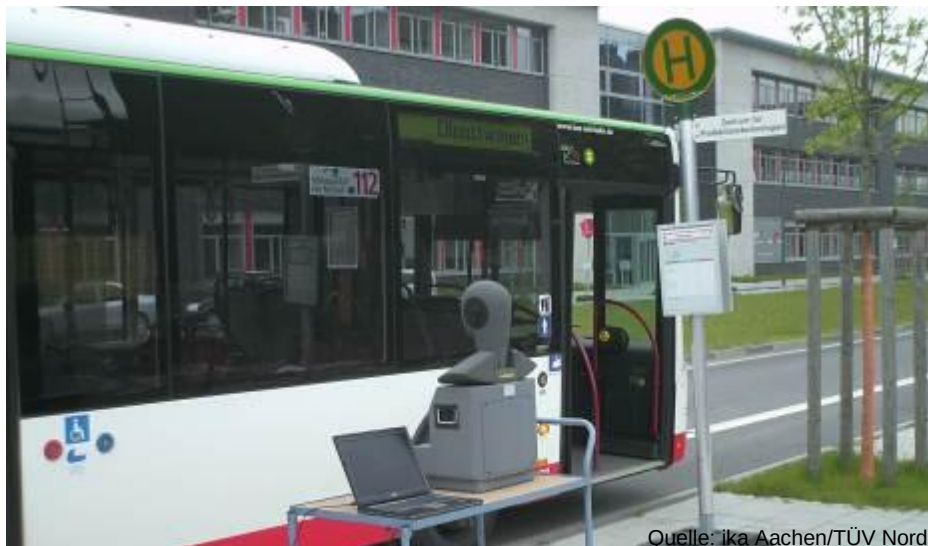
Abbildung 18 Einsatz des Kunstkopfmesssystems an einer Haltestelle
