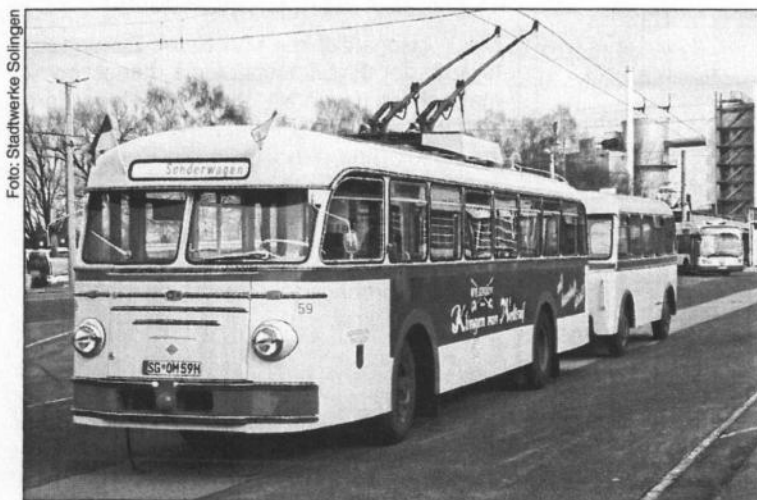
Abb. 1: ÜH III s O-Bus-Anhängerzug von Uerdingen/Henschedel mit Orion-Personenanhänger. Die Stadtwerke Solingen restaurierten diesen historischen O-Bus samt seinem Anhänger. Das Gespann soll nach Abschluss aller Arbeiten im Jahr 2013 auf dem Solinger O-Busnetz für Sonderfahrten eingesetzt werden.
