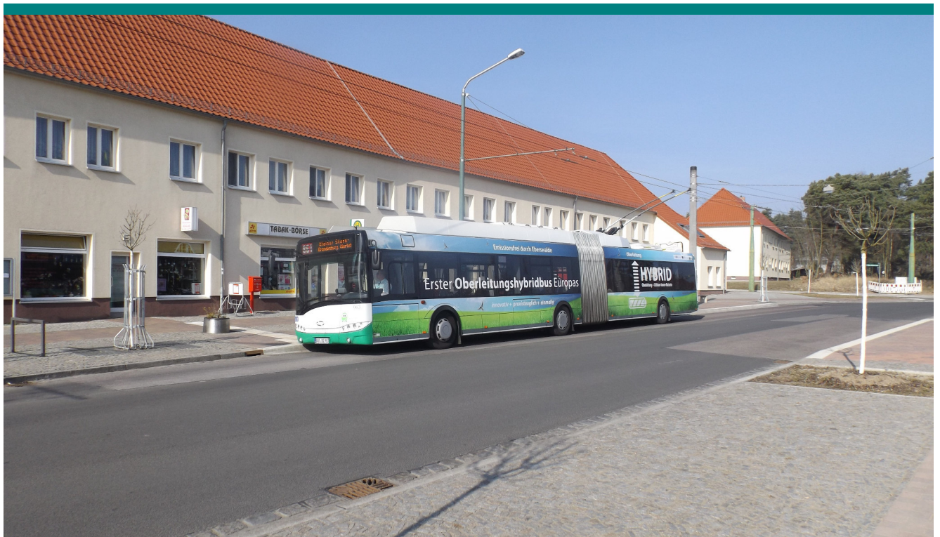
Abbildung 7: Der erste Elektro-Hybrid-Bus der Welt im Einsatz bei der Barnimer Busgesellschaft. Nach den erfolgreichen Tests mit einem Altfahrzeug, wurde ein neugeliefertes Fahrzeug entsprechend ausgerüstet. Der Bus kann oberleitungsfreie Abschnitte im Batteriebetrieb befahren. Die Batterie wird anschließend über die Oberleitung wieder aufgeladen.
