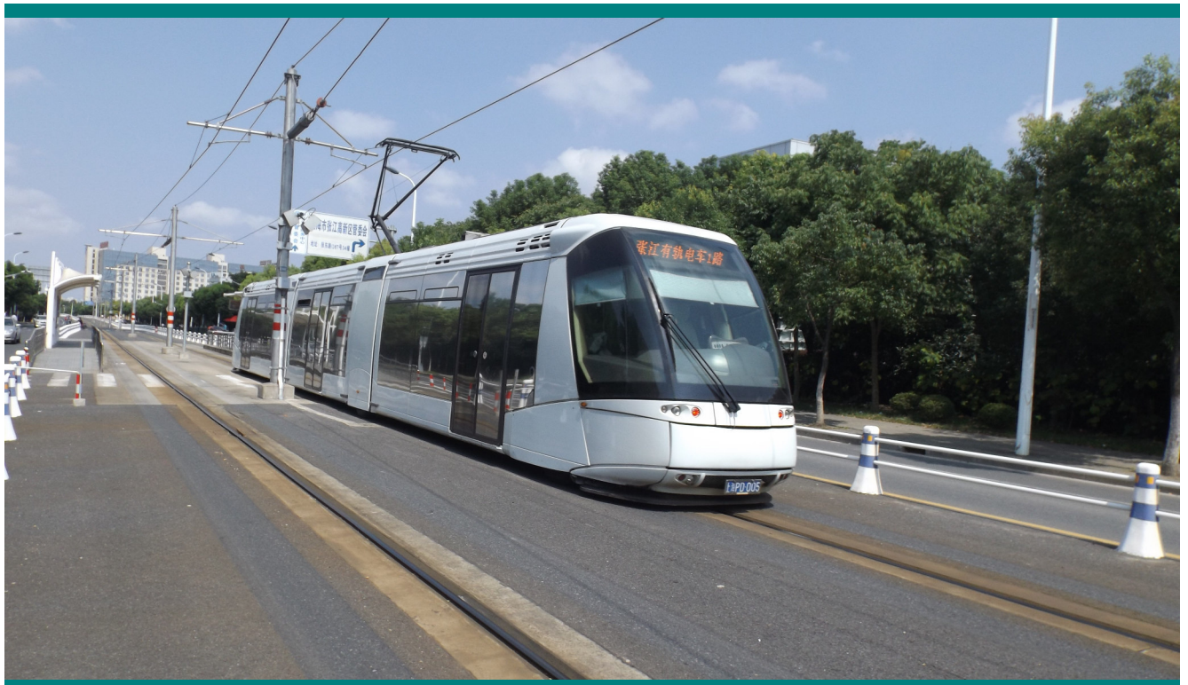
Abbildung 10: Der Ansatz war interessant. Leider vereint der Translohr ausgerechnet die Nachteile von Obus und Straßenbahn - Spurbundenheit und schlechte Laufeigenschaften. Dieses Verkehrsmittel ist zum flächendeckenden Ersatz des Obusses nicht geeignet.
