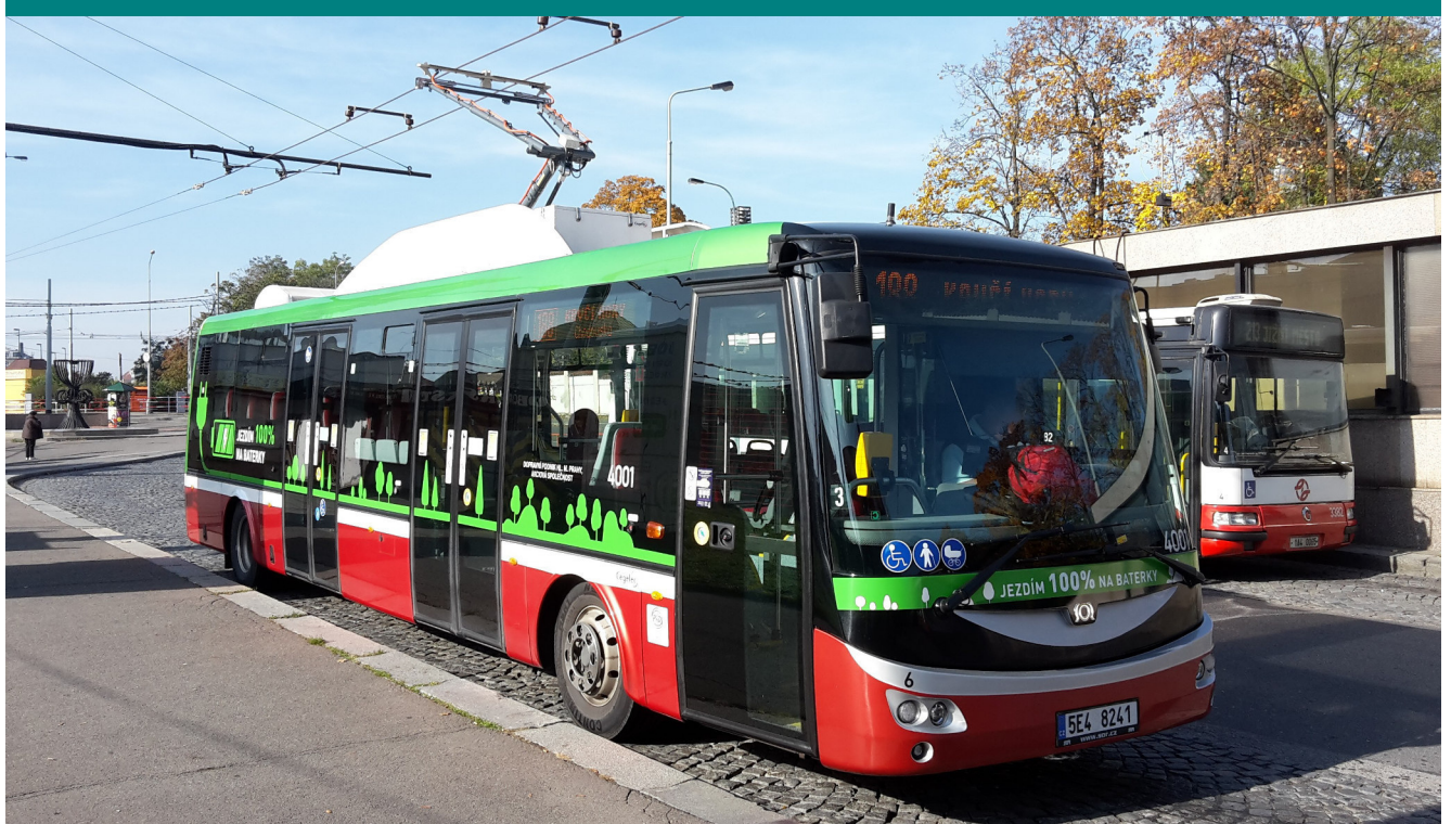
Abbildung 3: Ein Fahrzeug mit konduktiver Ladevorrichtung im Testeinsatz bei den Prager Verkehrsbetrieben. Zu erkennen ist die vom Obus übernommene Oberleitung, die im Bereich der Ladestation gespannt ist.
