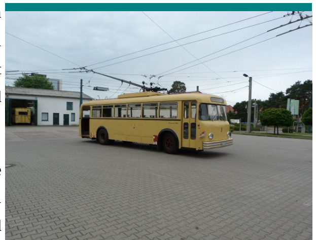
Abbildung 8: Bereits in den 1950er Jahren gab es Versuche bei der BVG-West, Obusse mit einer Batterienotfahrt auszurüsten. Der von Gaubschat mit E-Ausrüstung von AEG ausgerüstete Obus 488 kann ganz kurze Strecken ohne Fahrleitung überbrücken. Dieses Fahrzeug wird in Kooperation vom Deutschen Technikmuseum und dem Denkmalpflege-Verein Nahverkehr in Eberswalde einsatzfähig museal erhalten.
