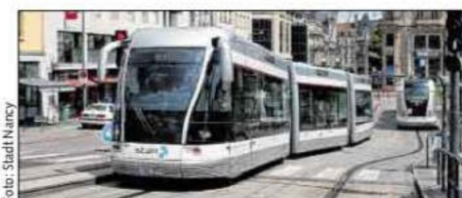
Nancy mit einem besonderen O-Bus-System: Einschienige Spurführung wie bei einer Tramway.
