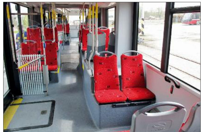
11. Salzburg 351, viertürig, mit Boden durchgehend auf Höhe 330 mm
