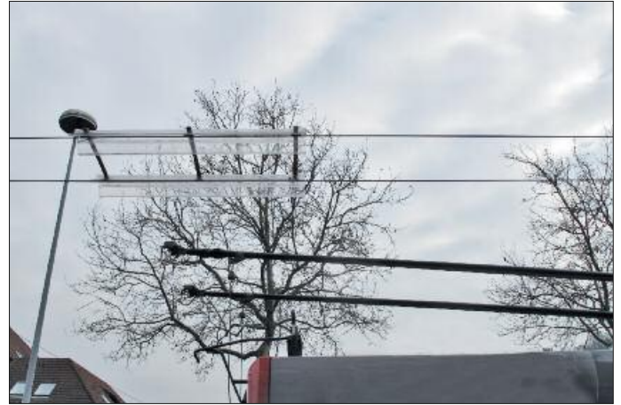
24. Eleganter Trichter am Zollberg; erlaubt An- und Abdrähten per Druckknopf
