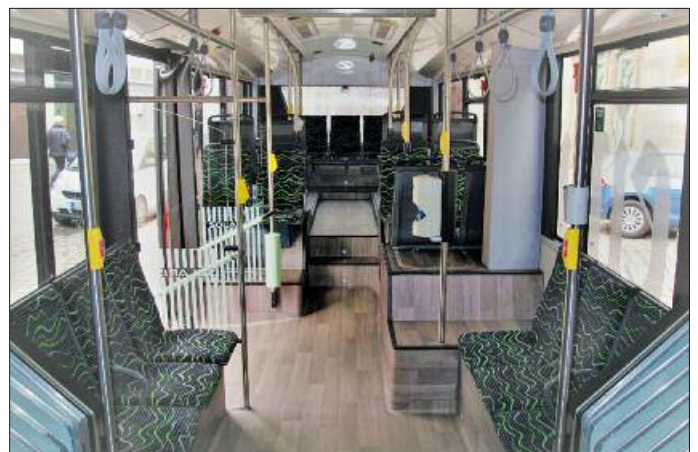
20. Metrostyle: Der hintere Teil komplett neu gestaltet wegen der Unterbringung der Batterien – man vergleiche mit Abbildung 11
