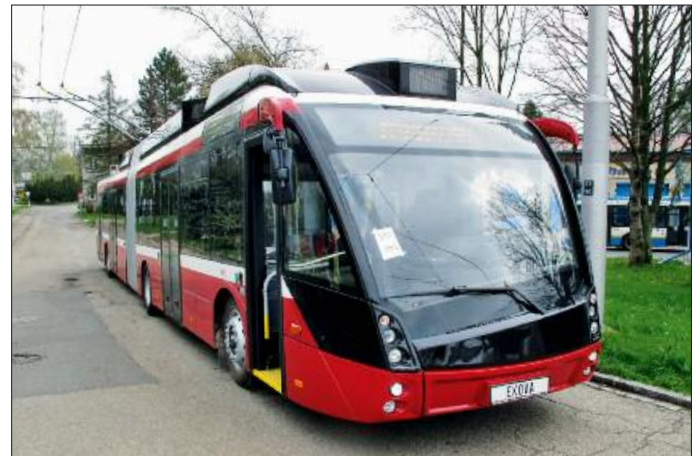
10. Solaris Metrostyle/Cegelec-Trolleybus 351 für Salzburg bei Ekova zur Endmontage und Erprobung
