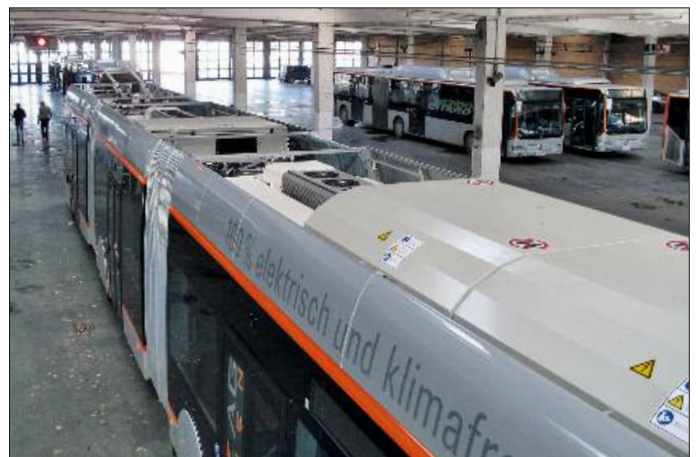
17. Das Dach von vorne (im Bild rechts) nach hinten: die zwei Wechselrichter, Klimaanlage, Traktionsbatterie, Klimaanlage, Stromabnehmer, Klimaanlage
