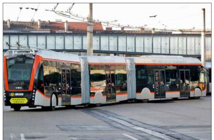
11. Demonstration der Zweiachsenlenkung, die in der Stadt sehr gut wirkt und dem Fahrzeug zu einer angemessenen Manövrierfähigkeit verhilft
