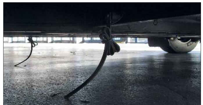
22. Schleifkontakte zum Abbau unerwünschter statischer Aufladung
