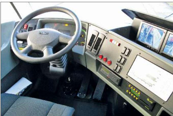
14. Fahrerplatz; keine Handbedienung für die elektrische Bremse, gestufte Fußbedienung
