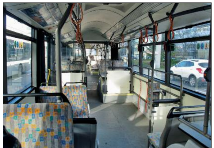
10. Volvo 7000A als Trolleybus Baujahr 2000; im Fahrgastraum befindet sich hinten kein Turm!
