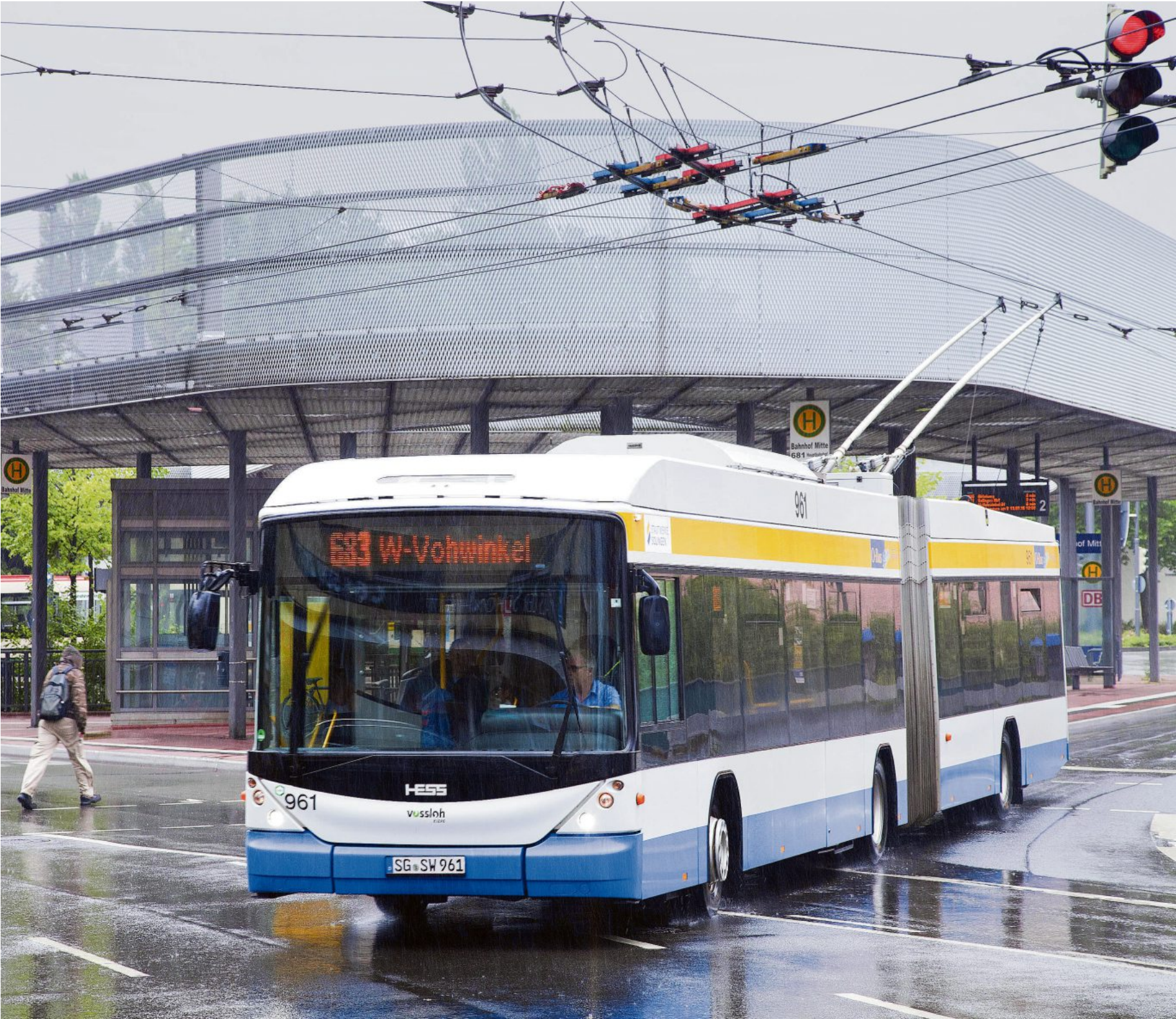
Strom-Abnehmer: Bisher haben Obusse wie dieser noch einen Diesel-Hilfsantrieb für Streckenabschnitte ohne Oberleitung. Künftig sollen sie dank eingebauter Speichertechnik überall in Solingen ausschließlich elektrisch fahren können – ohne dass das Oberleitungsnetz erweitert werden müsste.
