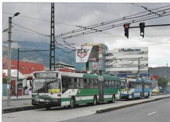
In Quito (Ecuador) wurde 1996 ein Trolleybussystem eröffnet, das teilweise BRT-Charakter aufweist. Nach über 100 elektrischen Fahrzeugen kamen zuletzt aber 80 Doppelgelenk-Dieselsbusse von Volvo/Marcopolo in Betrieb. Die Überholung von haltenden Bussen durch Expresskurse ist in Quito nicht verbreitet. Aufnahme: Karsten Göbel
