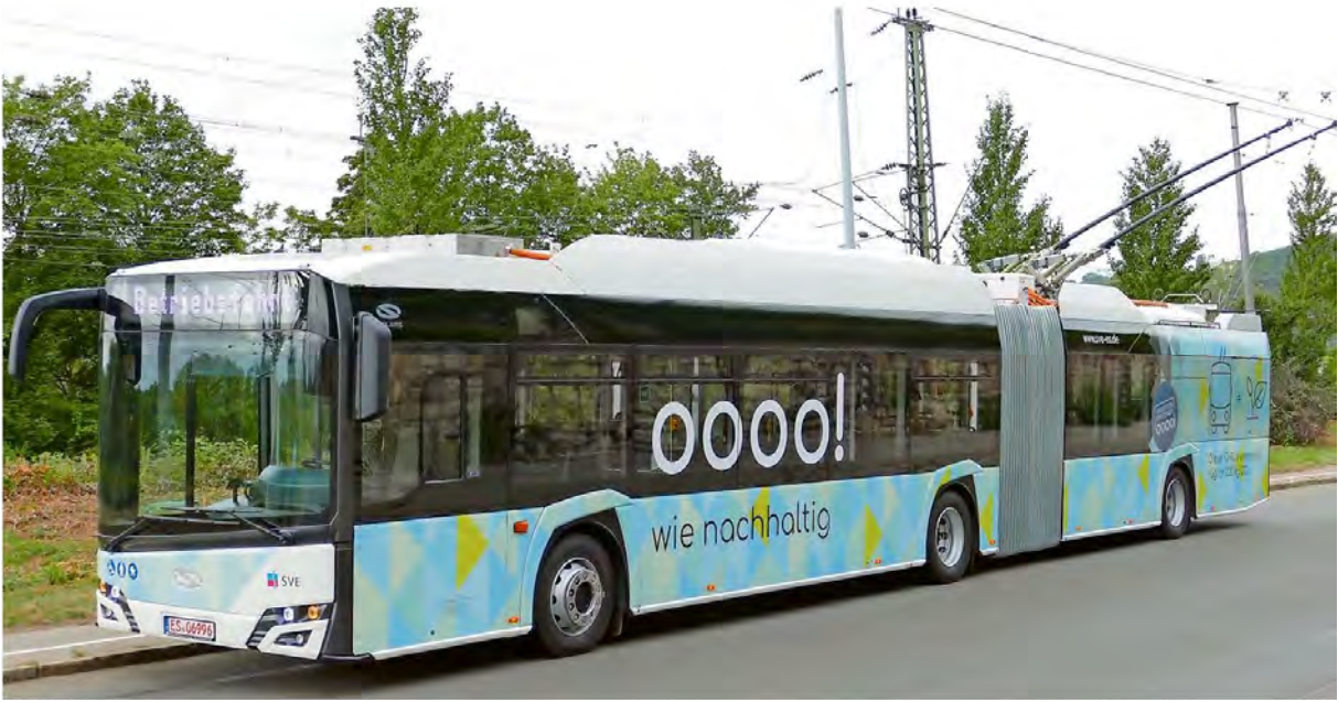
Heute geht's auch „leinenlos“: Ein moderner Oberleitungs-Elektrobus der Stadt Esslingen. Genau genommen ein Hybrid-Bus: Dank Batterie kann er auch bis zu 40 Kilometer ohne Oberleitung fahren. Zurück am Leitungsnetz in der Innenstadt „tankt“ er beim Fahren wieder Strom auf und spart sich die Ladepausen.
