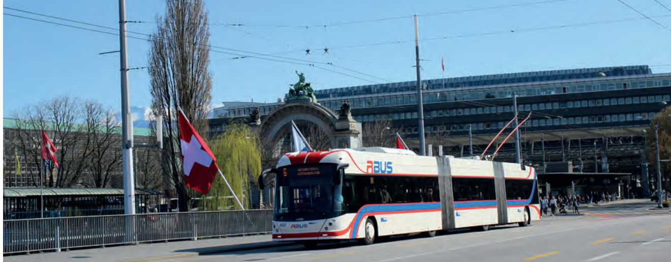
Vollelektrische Großraumbusse als Doppelgelenkwagen sind durch die kombinierte Batterie- und Trolleybusteknik problemlos machbar, mittlerweile hat die Firma Hess 118 Einheiten dieses 24,7 m langen Fahrzeugs in sechs Schweizer Städte geliefert, hier gleitet das lighTram® 25 DC Nr.403 vor dem Bahnhof Luzern auf die Seebrücke am Vierwaldstätter See entlang (Bilder: Jürgen Lehmann).
