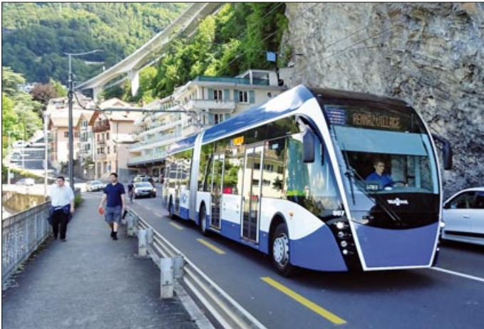
1. Batterie-Trolleybus Van Hool ExquiCity mit Kiepe-Ausrüstung an der Riviera Vaudoise auf dem Weg nach Rennaz Village über Hôpital de Rennaz. Der Bus misst 18 x 2,55 m, hat TSA-Motoren mit 2 x 120 kW und Batterien mit 30 kWh, 85 kW. Zwischen Villeneuve Gare und Rennaz Village wird auf 3 km (einfache Distanz) fahrdrahtlos gefahren. Aufnahme: Remontees, Lizenz: CC BY-SA 4.0
