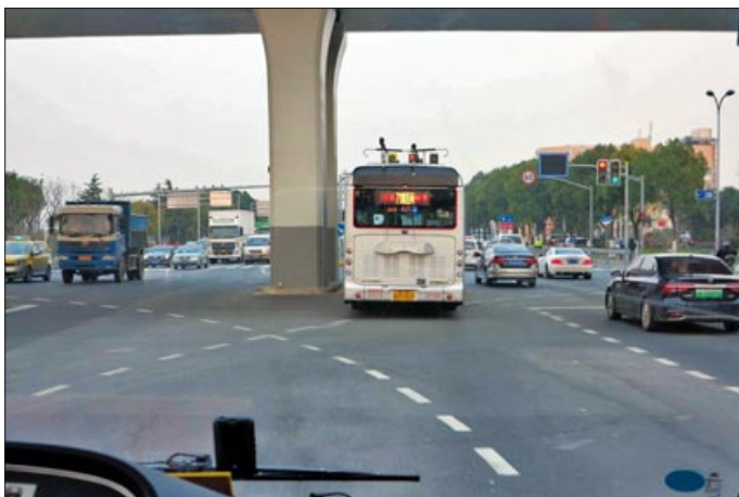
10. BRT-OL 71 passiert drahtlos eine Kreuzung Aufnahme: A. Bätzner
