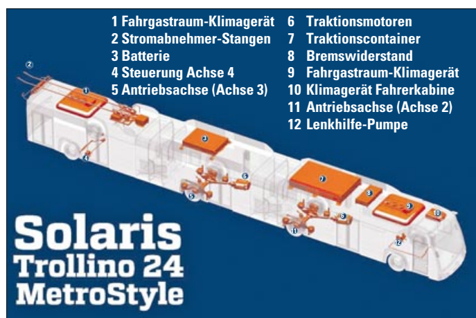
5. Solaris Trollino 24 Metrostyle/Cegelec mit viereinhalb Türen, Übersicht der Anordnung der Antriebsmodule und E-Geräte
