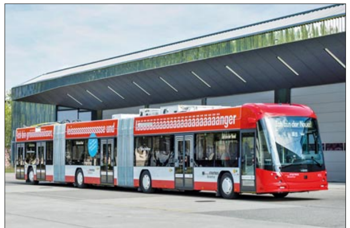
3. Präsentation des ersten von elf DGT-Batteriebussen Hess Lightram 5 25 mit viereinhalb Türen im Betriebshof in Winterthur Aufn.: Stadtbus Winterthur
