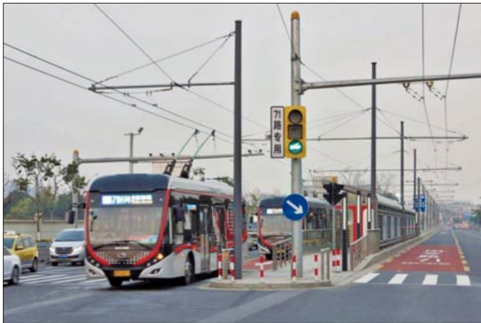
9. BRT-Obuslinie 71 in Shanghai, 12-m- und 18-m-Batterietrolleybusse in einem Land mit mehr als 60.000 reinen Batteriebussen! Aufnahme: A. Bätzner
