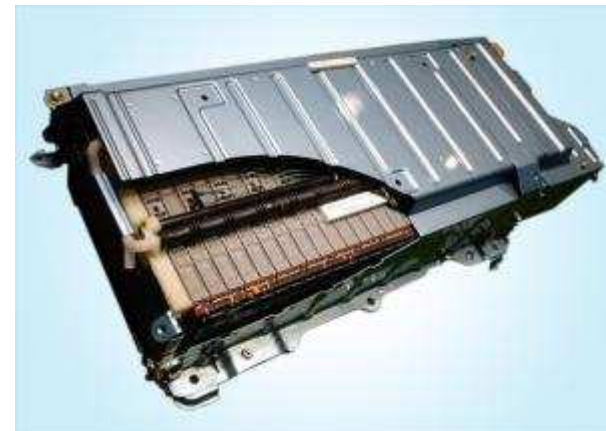
Toyota Prius NiMH Battery, 6,5 Ah, 288V (3 Module parallel), luftgekühlt
